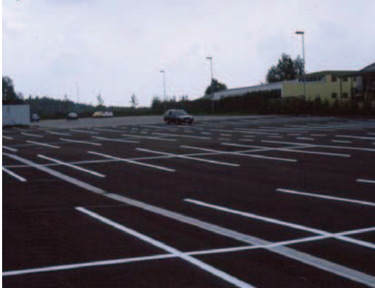
Bild 3-2: Wasserundurchlässige Befestigung bei Großparkplätzen
