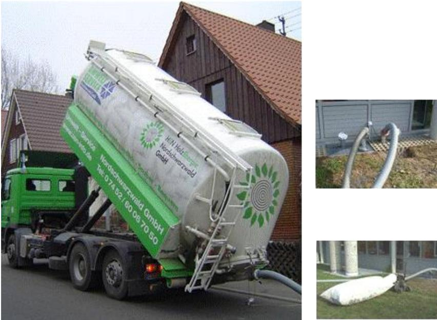
Abb. 10: Anlieferung Pellets mit Motorwagen
