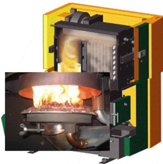
Pelletkessel im kleineren und mittleren Leistungsbereich sind meistens mit einer *Unterschubfeuerung* ausgestattet. Dabei werden die Pellets mittels einer Förderschnecke geregelt in Abhängigkeit der Heizlast von unten in einen Brennteller gedrückt und verbrennen dort. Die Asche fällt über den Teller rand in den darunterliegenden Aschebehälter.
